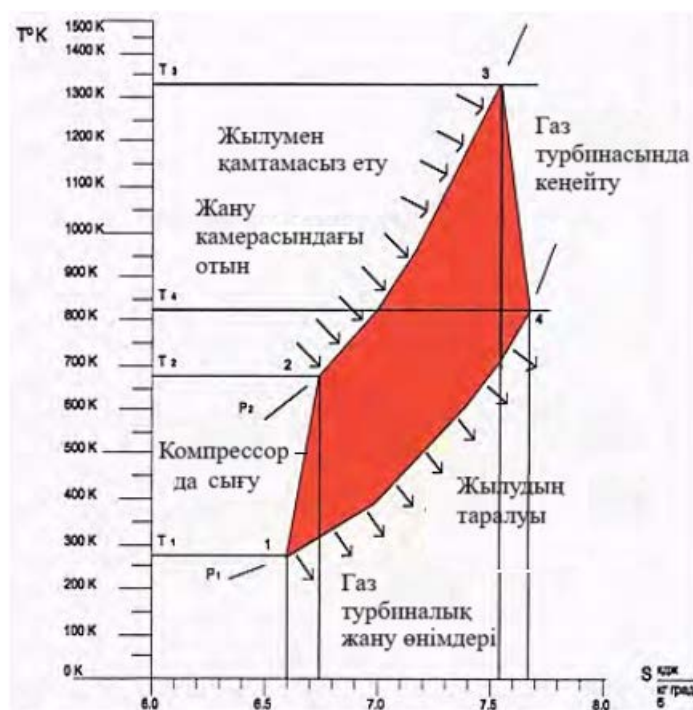
2.1 – сурет- TS – газ турбиналық циклінің диаграммасы
